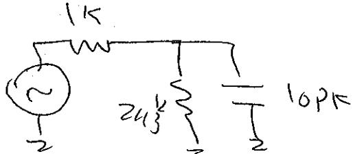
$$\tau = (1 \text{ K} \parallel 243 \text{ k}) \cdot 10 \text{ pF} = 1 \text{ K} \cdot 10 \text{ pF} = 10 \text{ ns}$$
